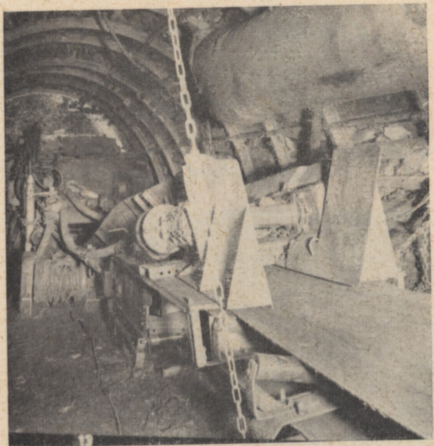
Übergabepanzer, Bandumkehr- und Schrapplader bilden eine Einheit
