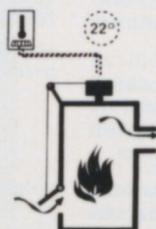
Die Raumtemperatur nimmt allmählich wieder ab. Sobald sie jedoch den eingestellten Wert von 22° etwas unterschreitet, läßt der Raumthermostat die Luftklappe wieder öffnen. Auf diese Weise wird die gewünschte Raumtemperatur ständig eingehalten.
