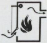
Der Regler (R) ist auf eine bestimmte Heizleistung eingestellt. Er hält die Luftklappe (L) so weit geöffnet, daß das Feuer in der richtigen Stärke brennt und die Heizleistung genau erreicht und eingehalten wird.
