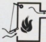
Im Laufe der Zeit sammelt sich Asche an und behindert die Luftzufuhr. Der Regler öffnet nun die Luftklappe weiter. Dadurch bleibt die Luftzufuhr in der bisherigen Stärke bestehen, und die Heizleistung wird weiterhin genau eingehalten.
