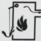
Hier haben sich die Windverhältnisse geändert. Der Schornsteinzug ist stärker geworden. Jetzt schließt der Regler die Luftklappe so weit, daß die eingestellte Heizleistung unverändert bestehen bleibt.
