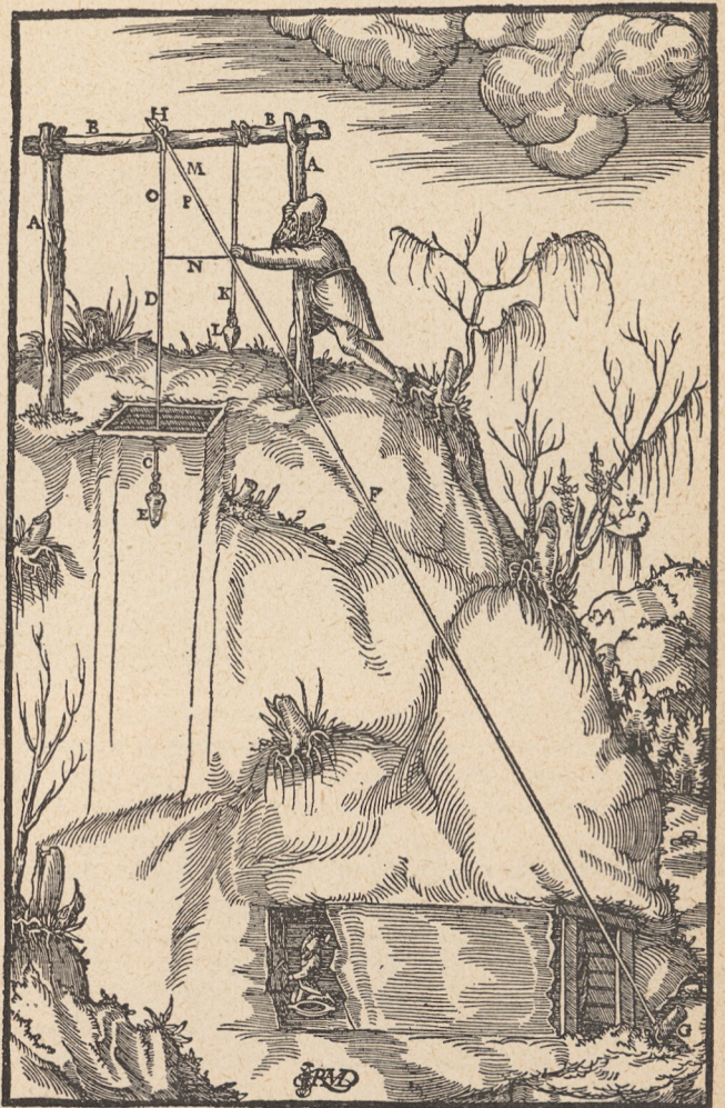
Das Joch A. Das Querholz B. Der Schacht C. Die erste Schnur D. Das Gewicht der ersten Schnur E. Die zweite Schnur F. Ihre Befestigung im Boden G. Der Anfang der ersten Schnur H. Das Stollenmundloch I. Die dritte Schnur K. Das Gewicht der dritten Schnur L. Das erste Maß M. Das zweite Maß N. Das dritte Maß O. Das Dreieck P.
