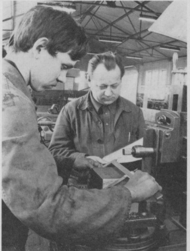
Ausmessung mit der Schieblehre bei Hobelarbeiten mit der Shapingmaschine
