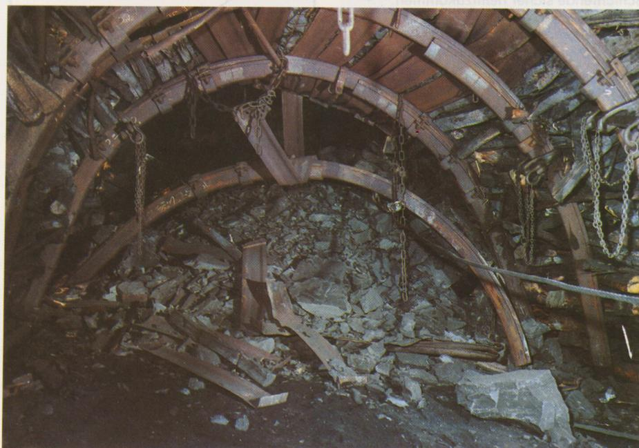
Falls das Raubgerät nicht mit eigenem Anschlaggeschirr (Kette und Gabelkopfklaue) versehen ist, muß eine Panzerkette mit Schäkkel und Schrauben verwendet werden. Der Anschlagpunkt an dem zu raubenden Bau kann beliebig gewählt werden. Dabei ist darauf zu achten, daß die Verbindung zwischen dem zu ziehenden Bau und der Raubvorrichtung sich nicht selbsttätig lösen kann.
