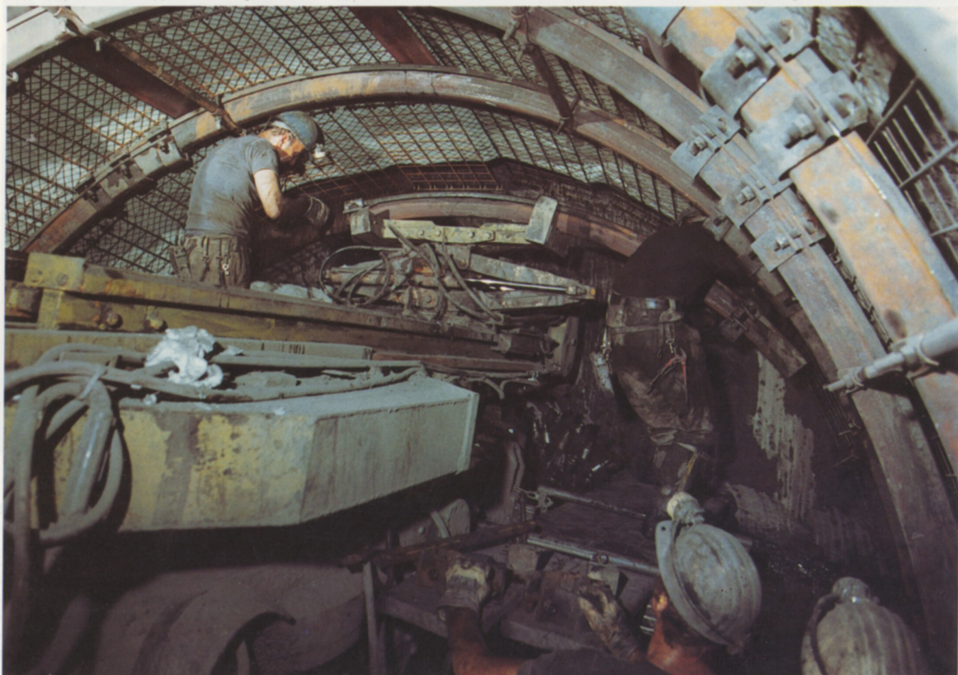
▲ Der hydraulische Kappenheber ausgefahren
