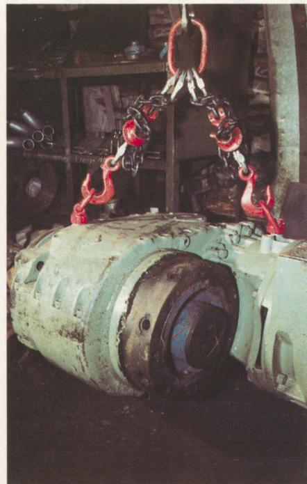
Anschlagblöcke und Anschlagmittel für das Bewegen und die Montage von schweren und sperrigen Lasten
