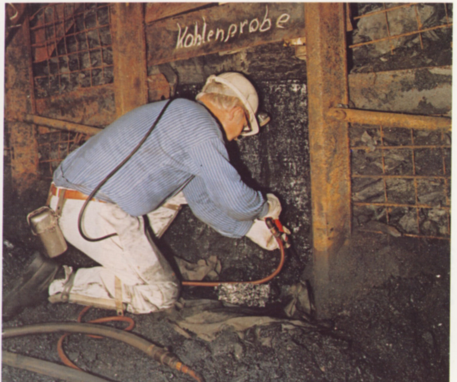
Lösen der Kohleprobe mit dem Abbauhammer
