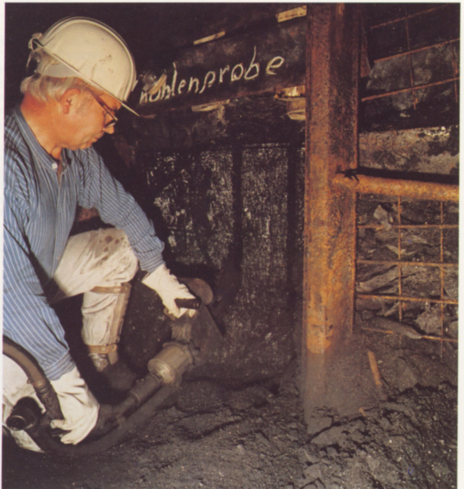
Vorbereitung des Flözprofils mit der Schrämkettensäge
