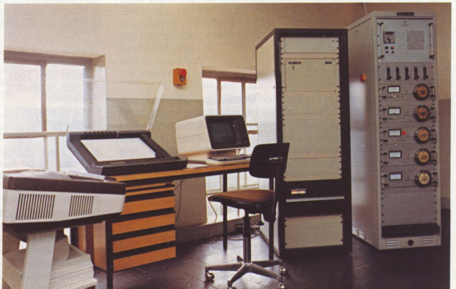
V. r. n. l.: Gasanalysestation, Meßwertaufzeichnung, Datensichtgerät, Plotter, Drucker
