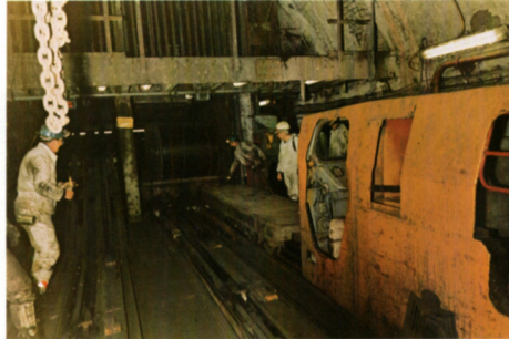
Abziehen des Wickelkerns vom Korb auf der 4. Sohle (Abb. 3)
