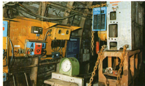
Haspelsteuerstand, Fahrkontrollgerät, Fahrmanweisungs-Tafel
