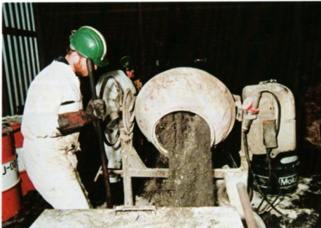
Mit Anthydrin konditionierter, kontaminierter Schlamm
