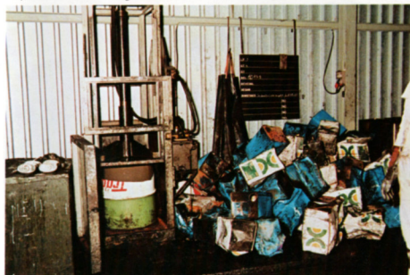
Faßpresse zur Reduzierung des Volumens von leeren Behältern
