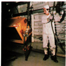
Der mögliche Kippwinkel liegt bei ca. 130°. Hubkette entlastet — Behälter hängt an der Kippkette.
