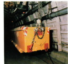
Angehobener stabilisierter Behälter. Schwerpunktgleich durch Stabilisierungskette.
