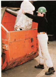
Ein Mitarbeiter füllt angeliefertes Altpapier aus dem Betrieb in den 30 m 3 -Preßcontainer
