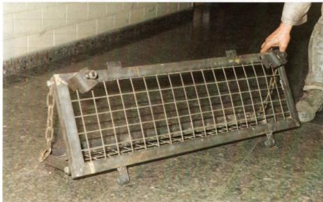
Firstsicherung: Klappbare Sicherungsmatte zum Schutz der Person vor Steinfall während des Stempelsensens u. a.
