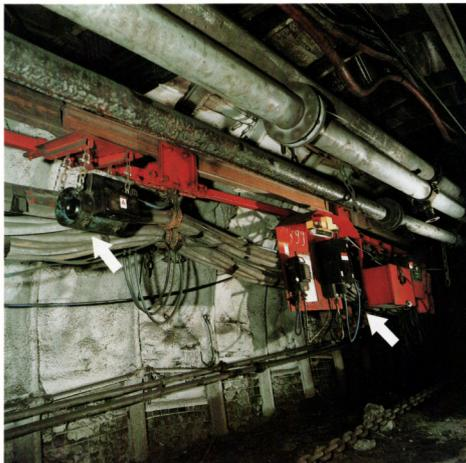
Feinstaubmeßanlage FMA-TMS.1 (Meßkopf und Zentralgerät siehe Pfeile)
