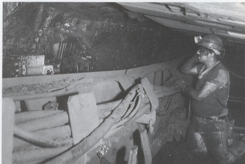
Abbau unter Tage – die Steuerung des Hobels erfolgt von der Hobelfahrersteuerwarte über Tage.
