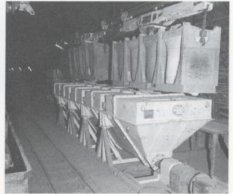
Baustoffumschlag an einer Wagenentladestation unter Tage, System KBI.
